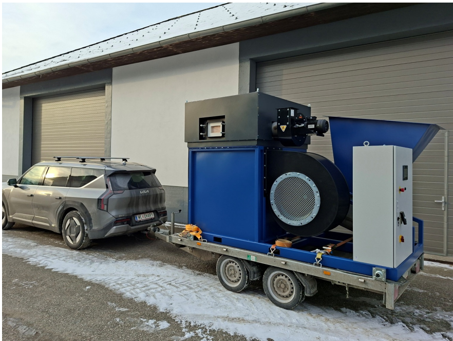
Mobiles Gerät (Biomasse 50 – 70 kg/h)
